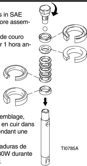
Avant d'effectuer l'assemblage, tremper les garnitures en cuir dans de l'huile SAE 30W pendant une heure.
