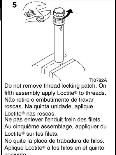
Do not remove thread locking patch. On fifth assembly apply Loctite® to threads. Não retire o embutimento de travar roscas. Na quinta unidade, aplique Loctite® nas roscas. Ne pas enlever l'enduit frein des filets. Au cinquième assemblage, appliquer du Loctite® sur les filets. No quite la placa de trabadura de hilos. Aplique Loctite® a los hilos en el quinto conjunto.
